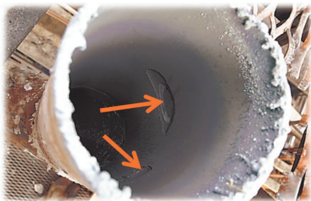
Рис. 1. Не обнаруженные традиционными методами НК дефекты типа «потери сечения» на трубопроводе DN 200
