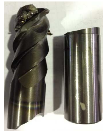
Рис. 2. Разрушение фрезы СКИФ 209
