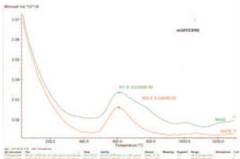
Рис. 8. Сравнительный анализ по температуре и интенсивности сигнала ионного тока для основных массовых чисел углеводородов ( m/z = 27 )
