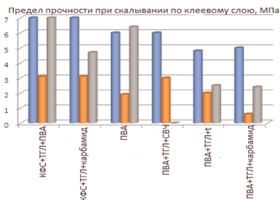
Рис. 1. Гистограмма зависимости скалывания по клеевому слою ламелей массивной древесины и показателей тепло- и морозостойкости от вида модификатора: ряд 1 — испытания на скалывание по клеевому слою; ряд 2 — испытания на скалывание по клеевому слою после определения теплостойкости; ряд 3 — испытания на скалывание по клеевому слою после определения морозостойкости
