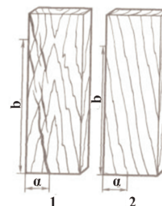
Рис. 2. Схема измерения наклона волокон: 1 — тангентальный наклон волокон в пиломатериале; 2 — радиальный наклон волокон на радиальной поверхности пиломатериала
