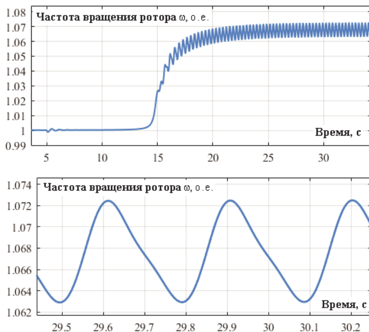
Рис. 4. Осциллограммы частоты вращения ротора турбогенератора при подключении дополнительной нагрузки в узле
